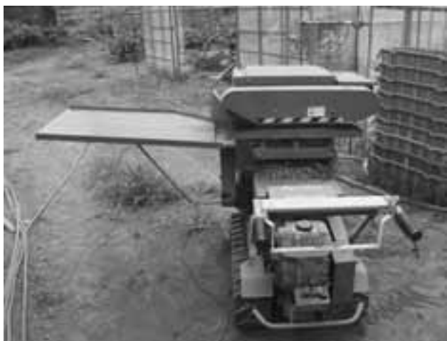
図2 自作の自走式脱莢機
